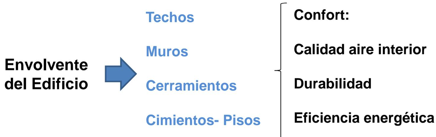
La envolvente *térmica* de una vivienda puede llegar a definir reducciones del consumo energético en climatización **del orden del 50% al 70%**
