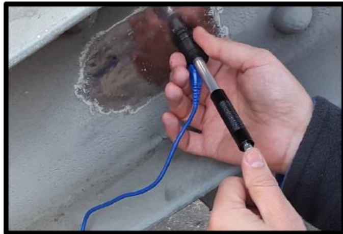
Ensayo en el sitio para determinar la Dureza Brinell
