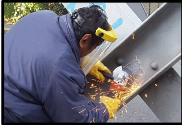
Preparación de la superficie para el ensayo de dureza
