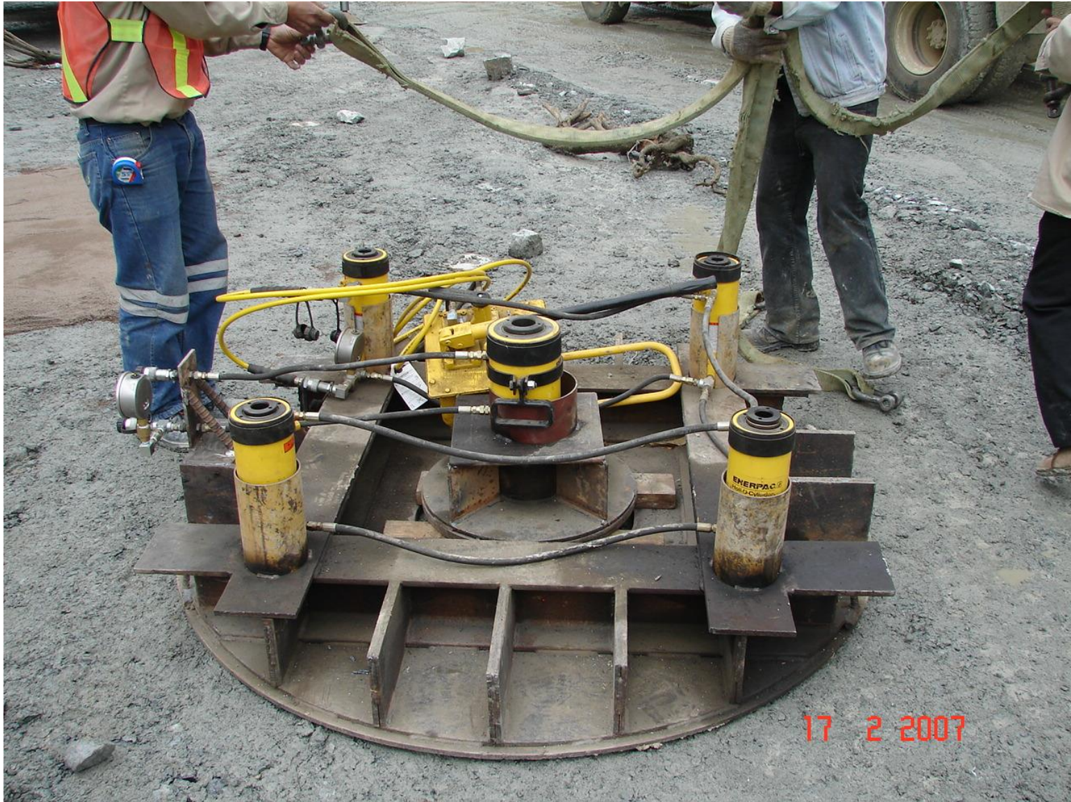
Presas Mazar – Ensayo de Placa
