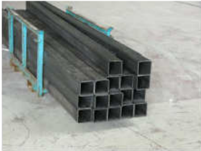
Emmagatzematge de perfil tubular soldats d'acer per a la fabricació de plaques de mòdul
