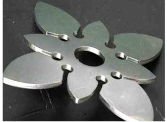
Pieza cortada por rayo laser
