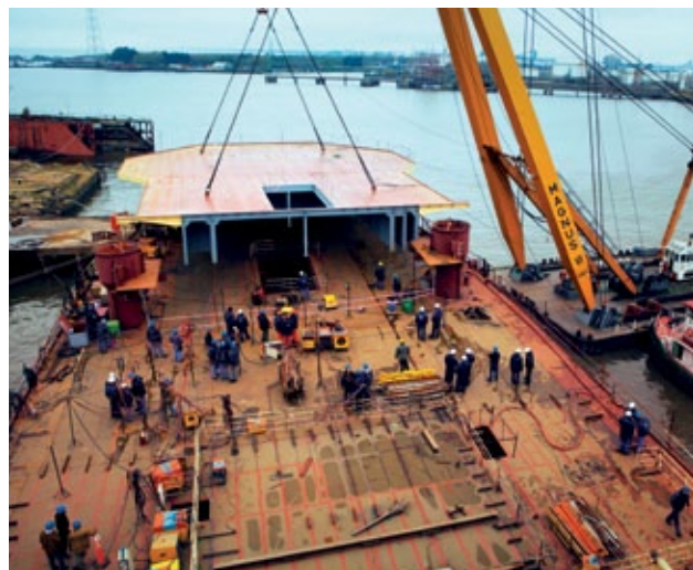
-CONSERVACIÓN. Del viejo Irizar sólo quedó el casco, líneas de ejes y hélices. El resto se hizo a nuevo.
