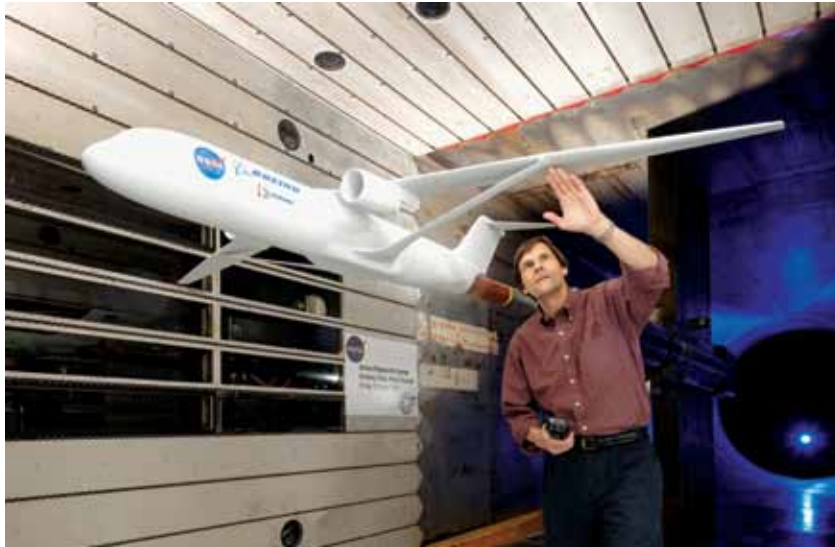
- MODELO. Las nuevas alas son tan largas que requieren un soporte adicional.
