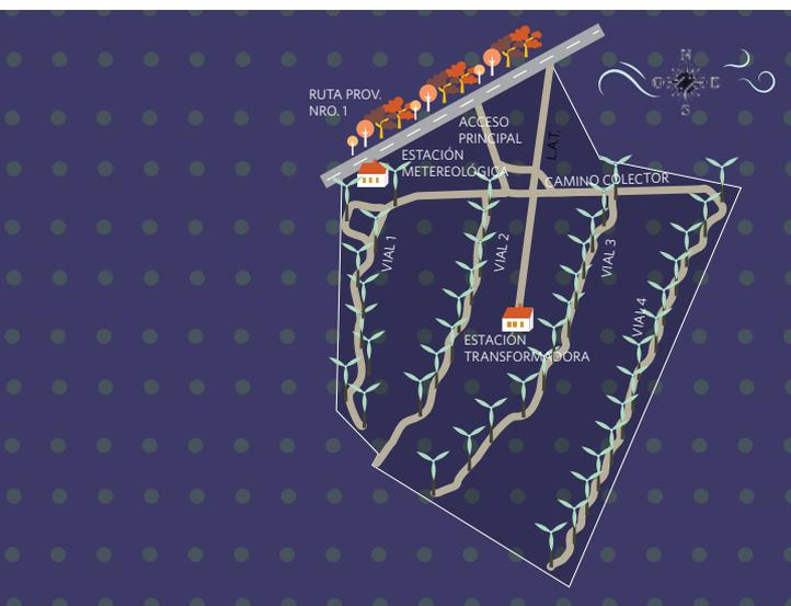
– PLANTA. **Disposición de los aerogeneradores.**
